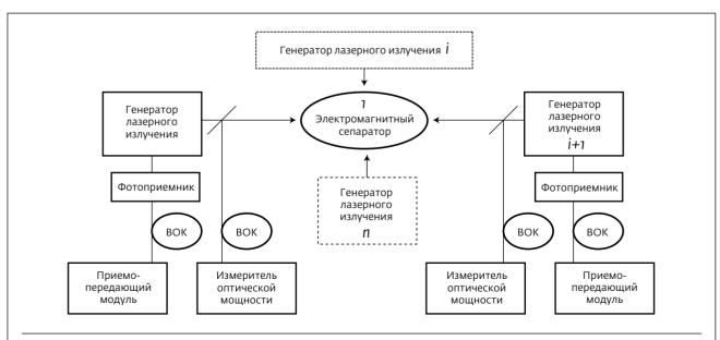
**Рис.1.** Фрагмент технологической установки, использующей линейку лазерных генераторов с синхронизацией и запуском по волоконно-оптическому каналу
