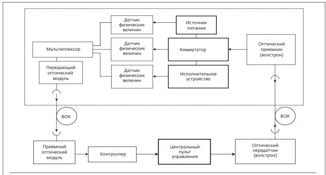
**Рис.2.** Функциональная схема электрофизической установки с замкнутым волоконно-оптическим каналом управления
